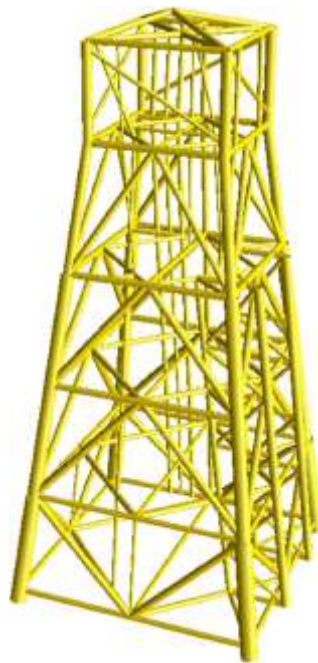
Figure 4 The four leg offshore jacket (Van Raaij & Gudmestad, 2007).
