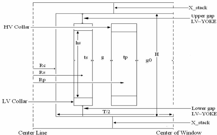
Fig. 1. Transformer output parameters (Masood et al., 2012)
