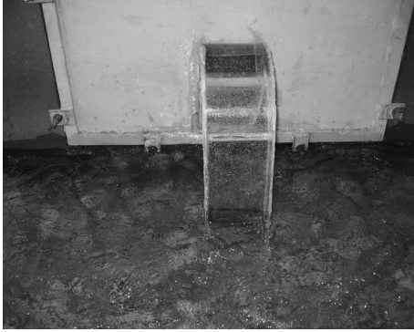
Fig. 9a. Full siphonic discharge
