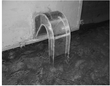
Fig. 9a. Full siphonic discharge
